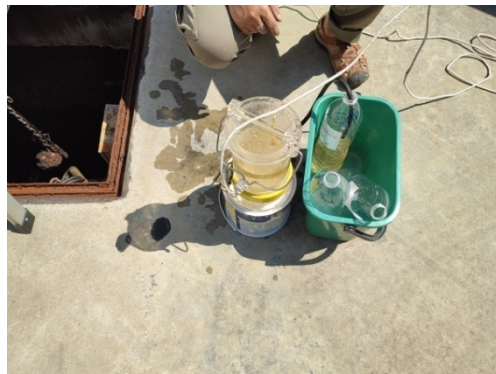
เก็บตัวอย่างน้ำทิ้งที่บ่อพักน้ำเสียหลังจากจากระบบบำบัดน้ำเสีย ด้วยวิธี Grab Sampling
