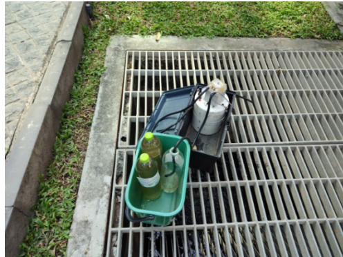
เก็บตัวอย่างน้ำทิ้งที่บ่อตรวจคุณภาพน้ำทิ้ง ด้วยวิธี Sampling Pump
